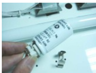
第四步驟-拆除電容器
